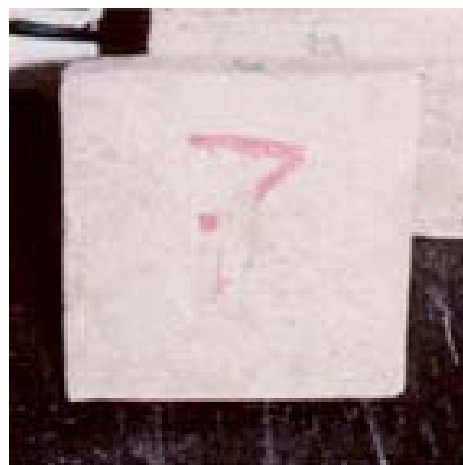
Figura 3. Abrasímetro Cap, ensaio de abrasão profunda e corpo-de-prova após o ensaio.
