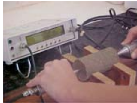
Figura 1. Equipamento Ultrasonic Tester BP-7 e as leituras sendo tomadas em um corpo-de-prova
