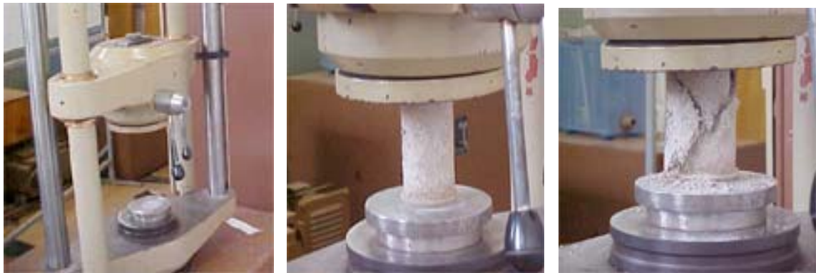
Figura 2. Corpo-de-prova sendo ensaiado à compressão simples
