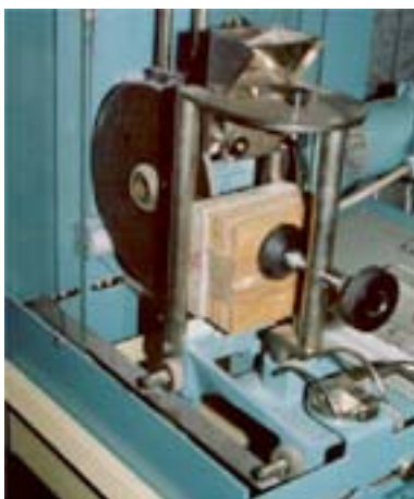
Figura 3. Abrasímetro Cap, ensaio de abrasão profunda e corpo-de-prova após o ensaio.
