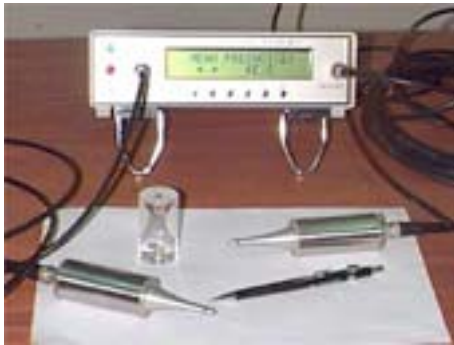
Figura 1. Equipamento Ultrasonic Tester BP-7 e as leituras sendo tomadas em um corpo-de-prova
