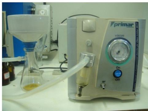
Figura 3 – Filtração à vácuo.
