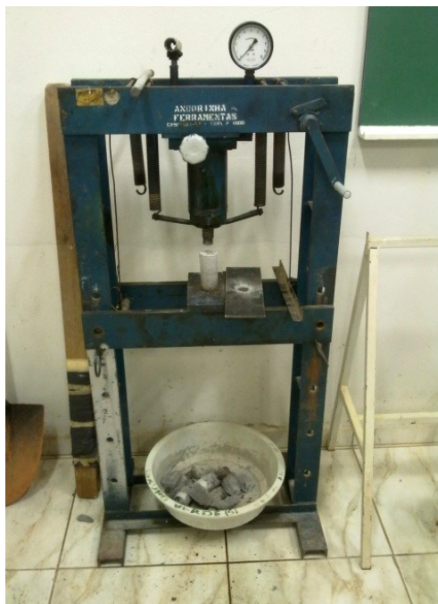
Figura 3. Prensa hidráulica para teste de resistência à compressão.
