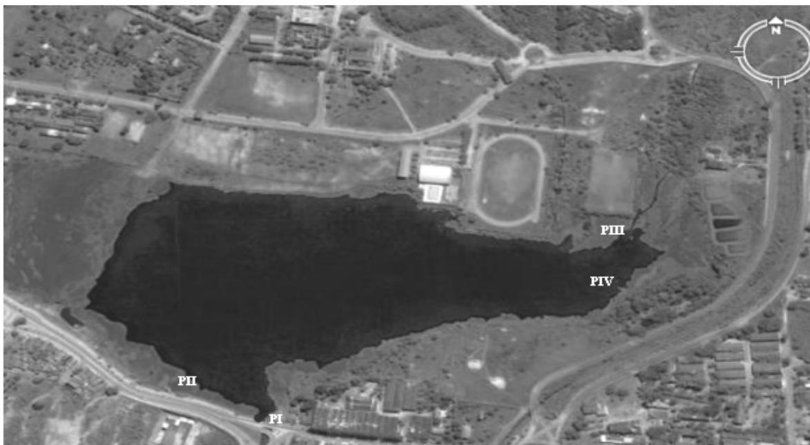
**Figura 1.** Imagem do Açude de Bodocongó mostrando o avanço do assoreamento ao longo do reservatório. Fonte: Carvalho et al, 2008.
