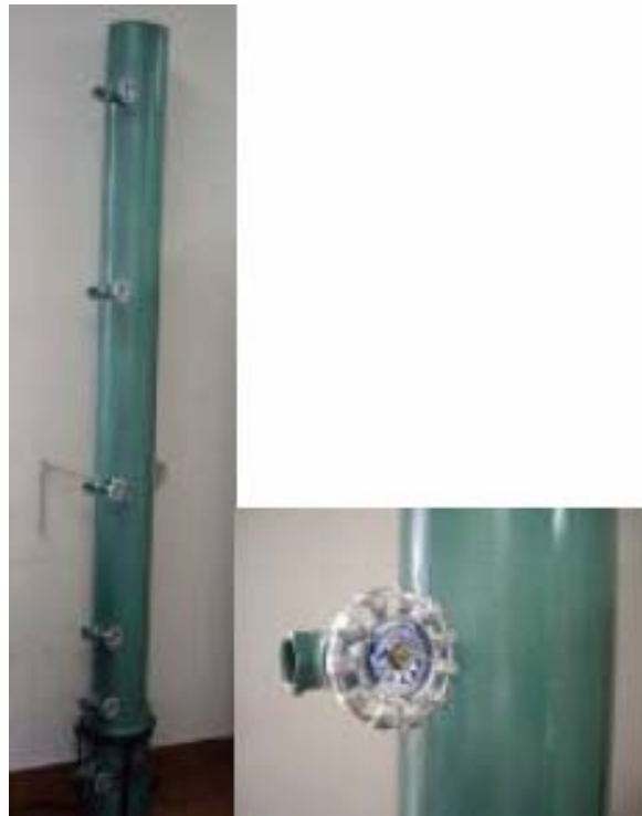
Figura 2. Coluna de sedimentação (esquerda) e detalhe do ponto de coleta de amostras (direita).
