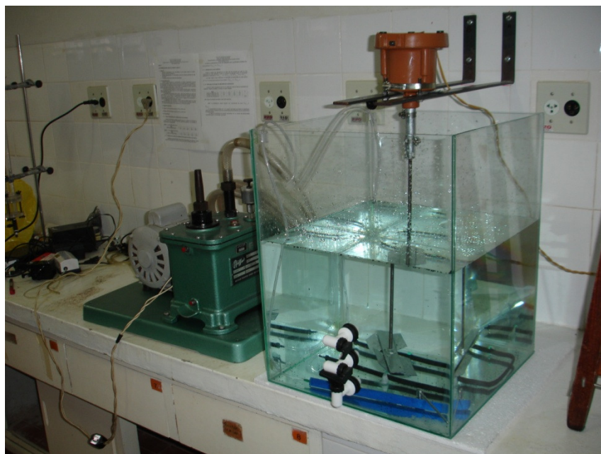
Figura 1. Esquema do reator no final da etapa de enchimento utilizando água como efluente.
