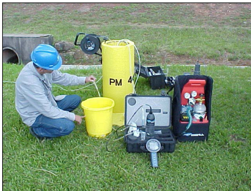
Figura 5. Sistema de baixa vazão instalado.
