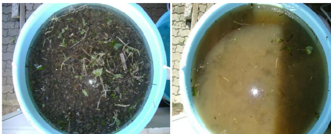
Figura 8 – Material sólido antes e durante a retrolavagem.
