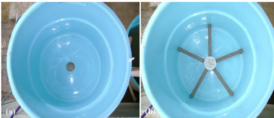
Figura 2 – (a) Vista superior da caixa de 250 litros com seu furo adaptado de 100 mm e (b) canos coletores de água acoplados em uma luva de 100 mm no fundo da caixa.
