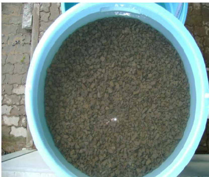
Figura 5 – Vista superior da última camada de 0,05 m do material filtrante de brita tipo 1.
