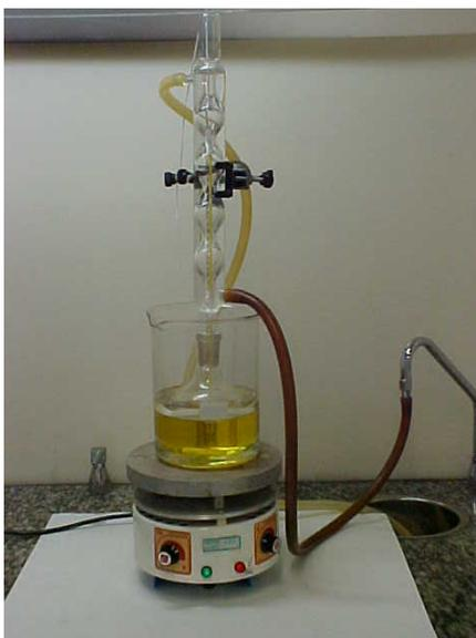
**Figura 3.** Reator utilizado para a produção do biodiesel
