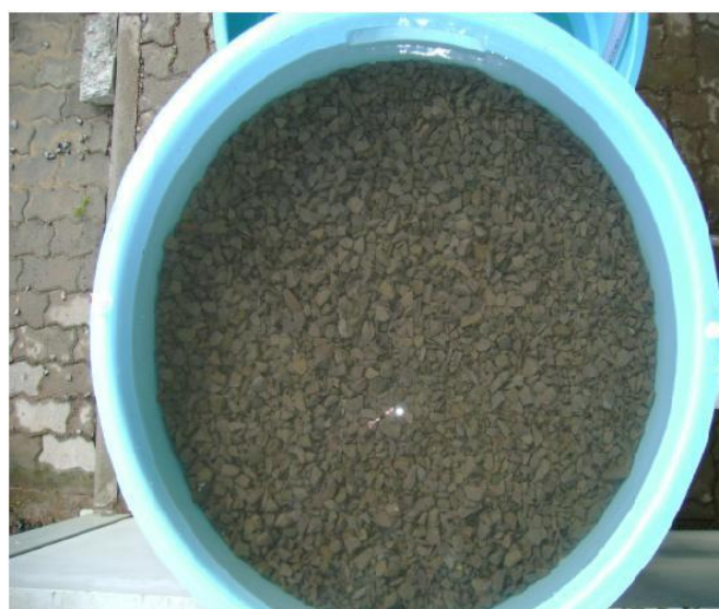
Figura 4 – Vista superior da última camada de 0,05 m de espessura do material filtrante de brita tipo 1.
