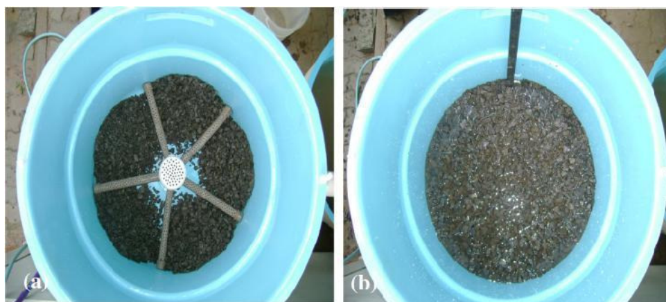
Figura 2 – Visualização da camada de 0,11 m de espessura de brita tipo 1 sobre os canos coletores de água.
