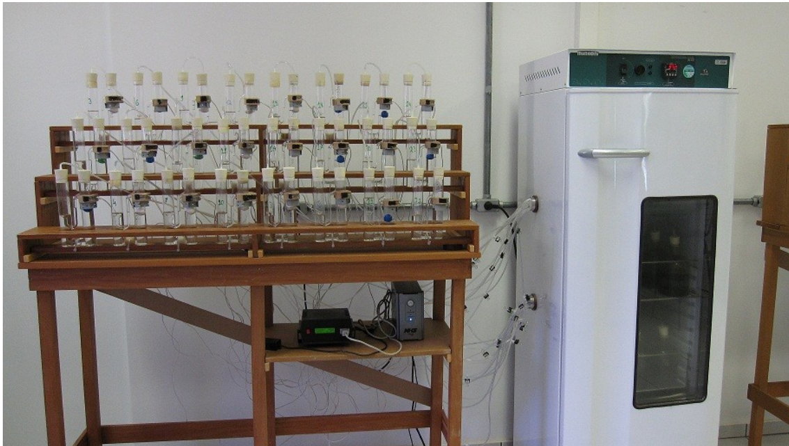
Figura 1. Sistema de quantificação de biogás em escala laboratorial.
