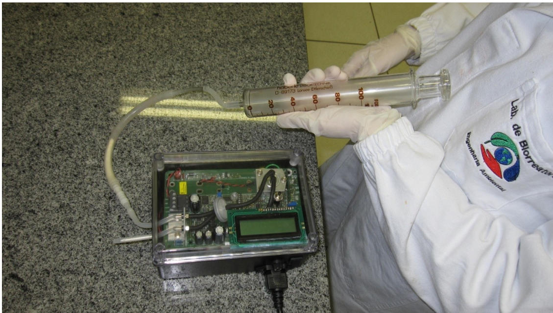
Figura 3. Sensor Advanced Gasmitter, empregado para a qualificação do biogás através da medição do percentual de metano.
