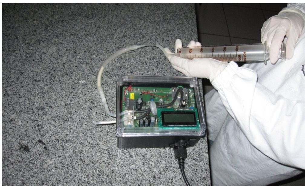
Figura 3 - Sensor específico para a medição de metano
