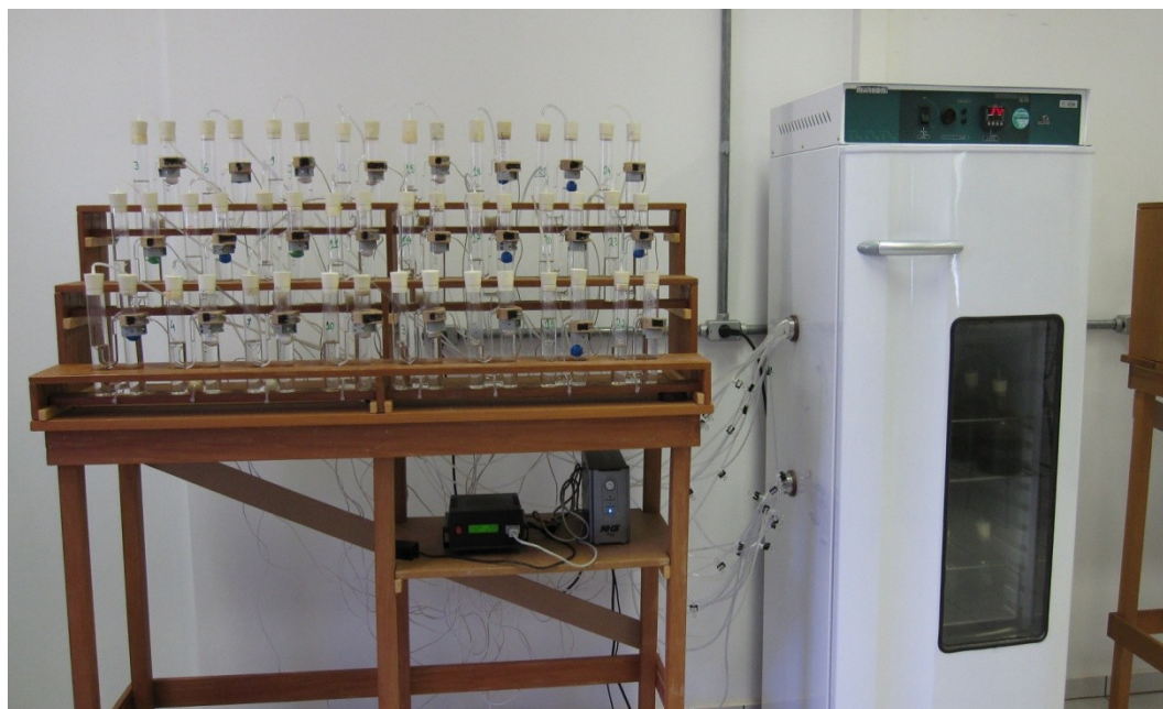
Figura 2 - Amostras incubadas conectadas ao sistema de medição de biogás
