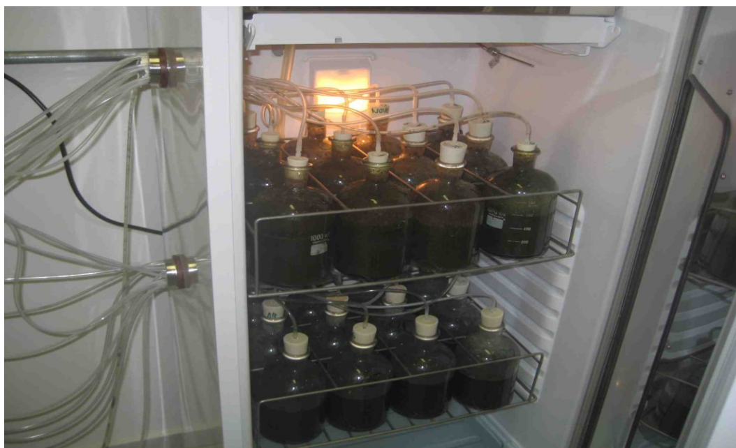
Figura 1 - Biodigestores acondicionados em incubadora bacteriológica adaptada.
