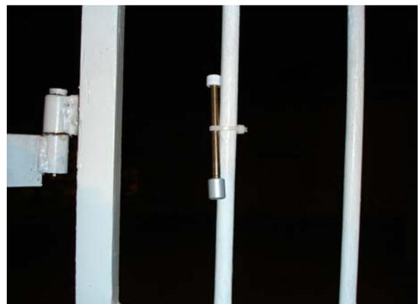
**Figura 1.** Tubo de aço utilizado para amostragem passiva de COV.
