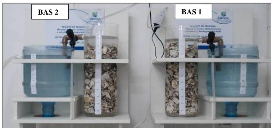
**Figura 1:** Biofiltros em escala laboratorial durante testes hidráulicos.
