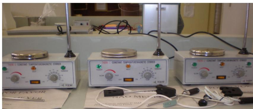
**Figura 3** – Simulação de uma unidade de coagulação (agitadores magnéticos).
