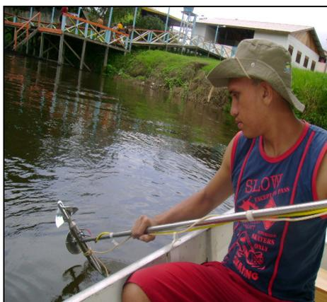
**Figura 5.** Molinete Universal Newton utilizado na seção de estudo do rio Maracá-AP.
