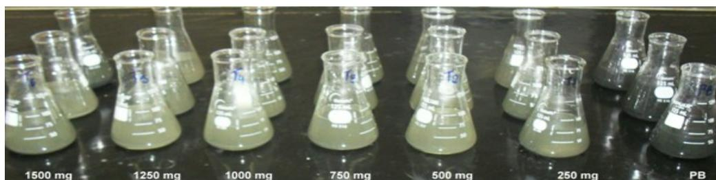
**Figura 4** – Ilustração do efeito de distintas dosagens de moringa no tratamento de água residuária oriunda do processamento da castanha de caju.
