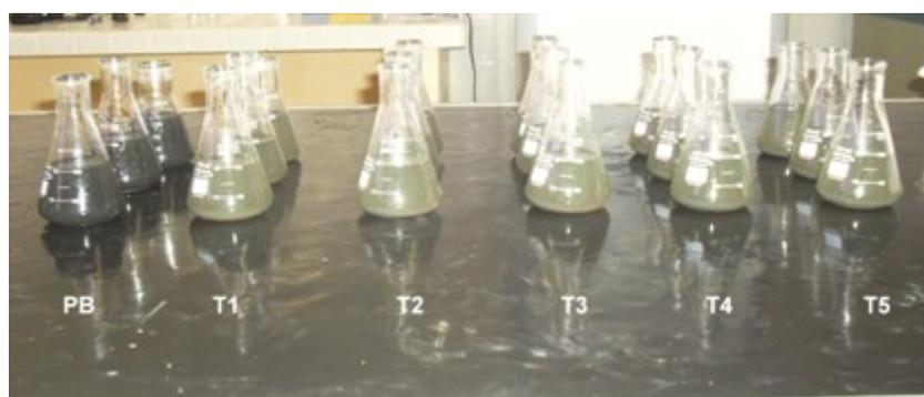
**Figura 3** – Ilustração do efeito de distintos tempos de sedimentação no tratamento de água residuária oriunda do processamento da castanha de caju.
