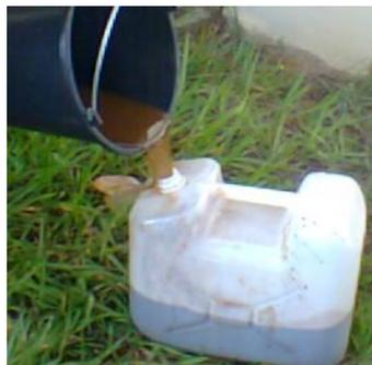
Figura 1. Coleta do lodo na ETA.
