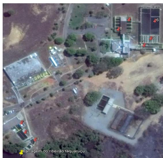
Figura 2. Vista aérea da ETA-6 e das etapas do tratamento da água. 1) Gradeamento; 2) Caixa de areia; 3) Estação elevatória; 4) Coagulação; 5) Floculação; 6) Decantação; 7)
