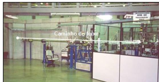
**Figura 4.** Tubulação do anel para a linha DO9B – XRF do LNLS. **Fonte:** LNLS, s.d.
