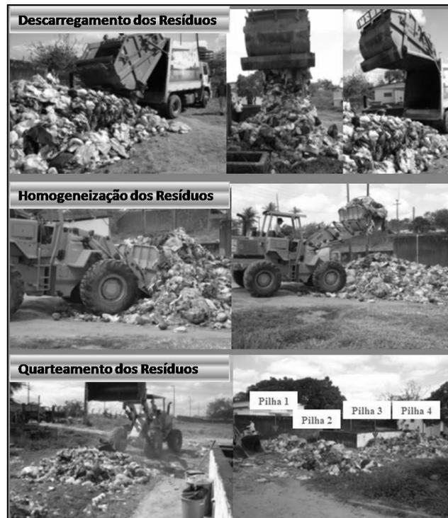
**Figura 3:** Descarregamento (1), homogeneização do material (2) e divisão das pilhas (3).
