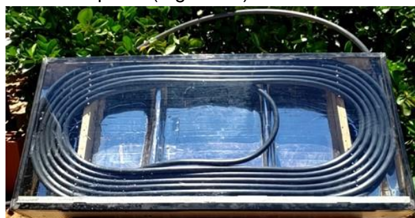
Figura 11: Placa do aquecedor finalizada Fonte: Próprio autor (2021)
