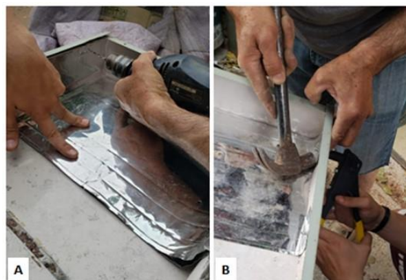
Figura 4: A) Furação para fixação da chapa na caixa; B) Fixação das chapas utilizando rebites Fonte: Próprio autor (2021).
