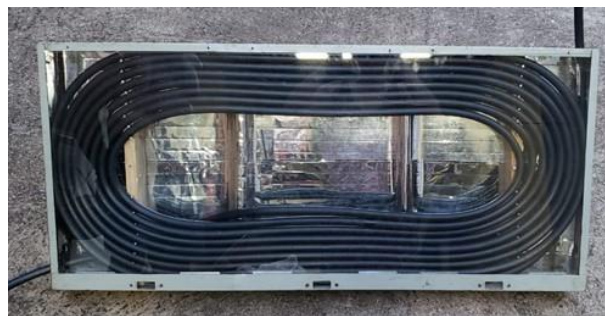
Figura 10: Placa do aquecedor sendo fechada Fonte: Próprio autor (2021)
