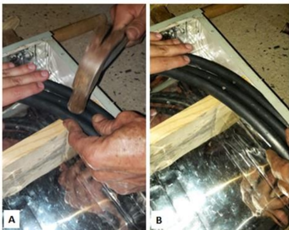
Figura 8: A) Fixação dos pregos; B) Pregos fixados auxiliando a formação da serpentina Fonte: Próprio autor (2021)
